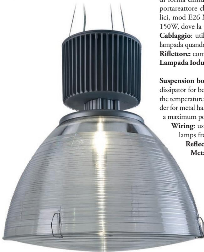
**Corpo sospensione:** pressofusione di alluminio verniciato con polveri epossidiche, di forma cilindrica con alette per una miglior dissipazione del calore sia sul vano portatore che nella sede del portalampada mod. E39 Mogul per ioduri metallici, mod E26 Medium-Base per lampade alogene fino ad una potenza massima di 150W, dove la temperatura rimane sotto gli standard prescritti.
