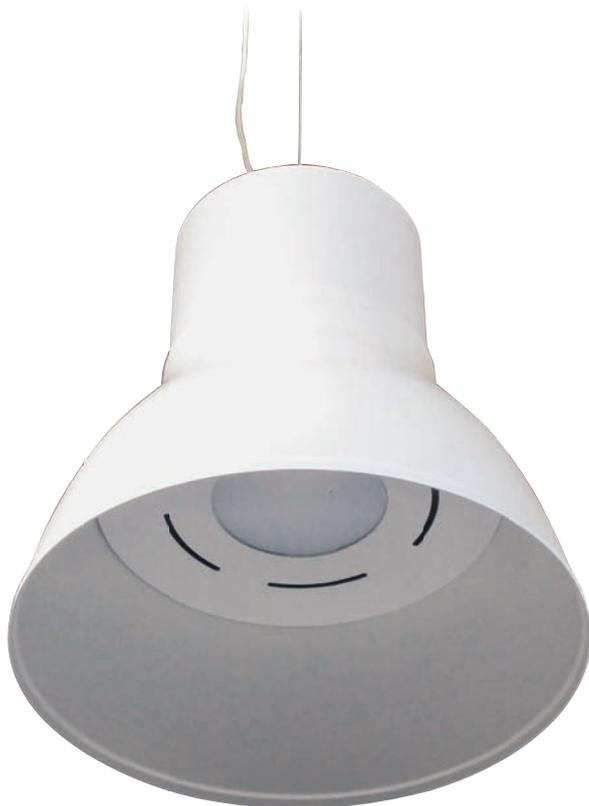
Lampada a sospensione. Corpo diffusore, disco ventilazione e rosone in alluminio verniciato. Riflettore in alluminio satinato. Schermo protettivo in materiale Satinice per una eccellente trasmissione, diffusione e brillantezza della luce. Utilizzo di sorgente luminosa LED COB. Alimentazione integrata dimmerabile 0-10V.
