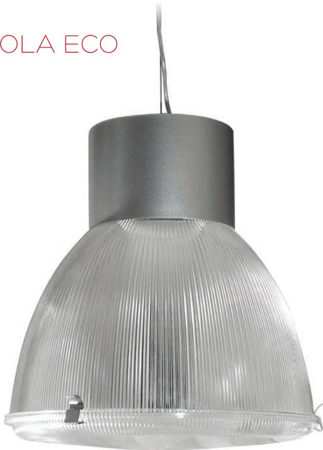
Lampada a sospensione con montatura in metallo verniciato alu sat (10). Diffusore in PC. Schermo di protezione in PC (opzionale). Cavo lungh. 59.1 pollici. Alimentazione inclusa nell'apparecchio 120V o 277V 60Hz.
