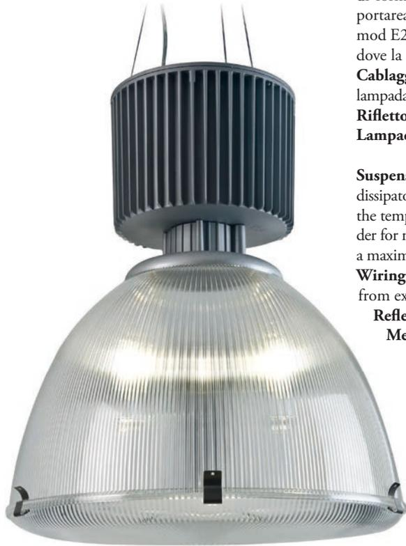
**Corpo sospensione:** pressofusione di alluminio verniciato con polveri epossidiche, di forma cilindrica con alette per una miglior dissipazione del calore sul vano portareattore che nella sede del portalamпада mod. E39 Mogul per ioduri metallici, mod E26 Medium-Base per lampade alogene fino ad una potenza massima di 150W, dove la temperatura rimane sotto gli standard prescritti.
