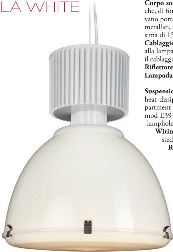
**Corpo sospensione:** pressofusione di alluminio verniciato con polveri epossidiche, di forma cilindrica con alette per una miglior dissipazione del calore sia sul vano portareattore che nella sede del portalampada mod. E39 Mogul per ioduri metallici, mod E26 Medium-Base per lampade alogene fino ad una potenza massima di 150W, dove la temperatura rimane sotto gli standard prescritti.
